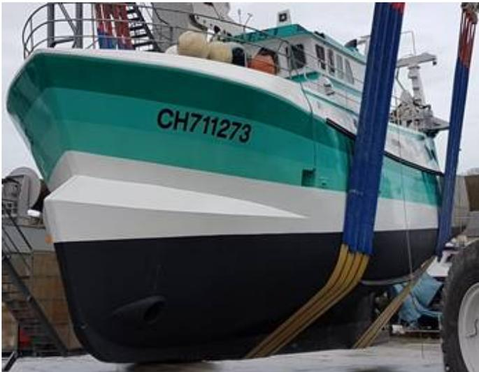
Transformation du chalutier "Sandra Kevin Dylan" (11,99m) : Transformations de la passerelle et création d'un gaillard, relevé des formes, dessin des nouvelles formes pour adapter le navire aux métiers pratiqués, plans de structure des modifications, stabilité
